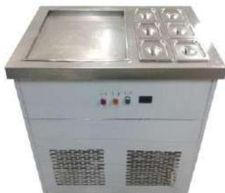
**MÁQUINA DE HELADO FRITO DE 1 TINA RECTÁNGULAR + 6 INSERTOS MARCA SNOWKY BY MIGSA**. FABRICADO EL GABINETE EN ACERO INOXIDABLE, UNA TINA DE FONDO PLANO DE 48 X 48 X 2 CMS. INCLUYE 6 INSERTOS PARA TOPPING. PRODUCCIÓN DE HELADO FRITO DE 13 A 15 LITROS POR HORA. CONTROL DIGITAL DE TEMPERATURA. SISTEMA DE DESHIELO POR BOTÓN. COMPRESOR DE 750 WATTS A 110V 60HZ (MONOFÁSICO), CON REFRIGERANTE 410A. PESO NETO DE 50 KGS.
